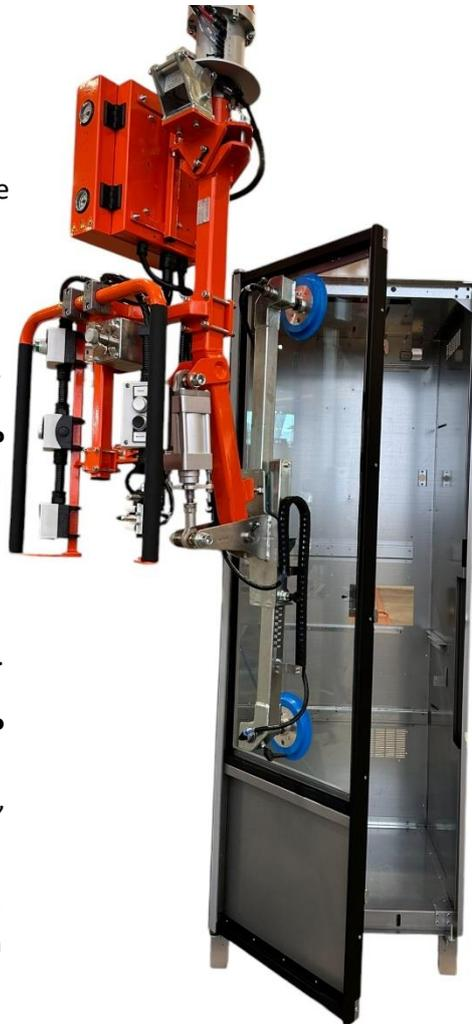
La configuration personnalisée du système de préhension à ventouses a été spécialement conçue pour répondre aux besoins de la manipulation du verre. La flexibilité des ventouses, combinée à la capacité du manipulateur, permet de manipuler les modèles les plus lourds en toute sécurité et efficacité.
