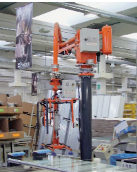
La posizione degli operatori all'assemblaggio delle cabine doccia Novellini, dotate di manipolatori pneumatici Atis.
